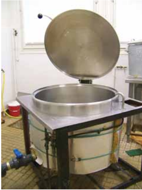
Photo 5 : Bac à graisse utilisé pour le dégraissage des os
