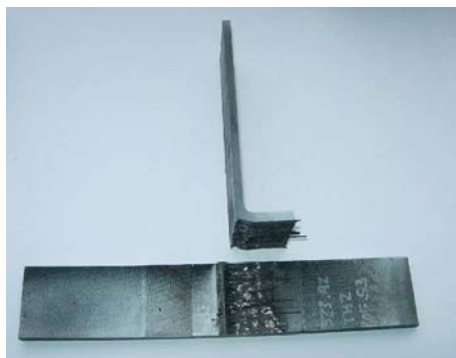
Figure IV-47 : Eprouvette en L non clouté (interface 0°/90°) après essai
