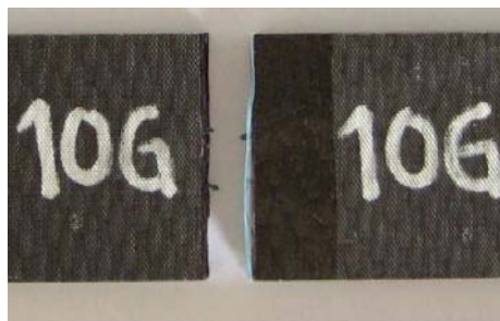
Figure III-78 : Eprouvette avec clous croisés après essai
