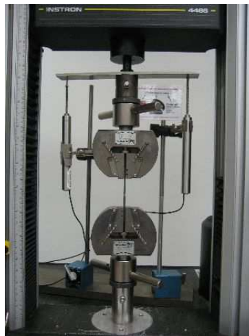
Figure III-3 : Montage d'essai de traction sur clou
