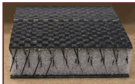
Figure II-15 : Sandwich, âme à base de clous (X-cor®)
