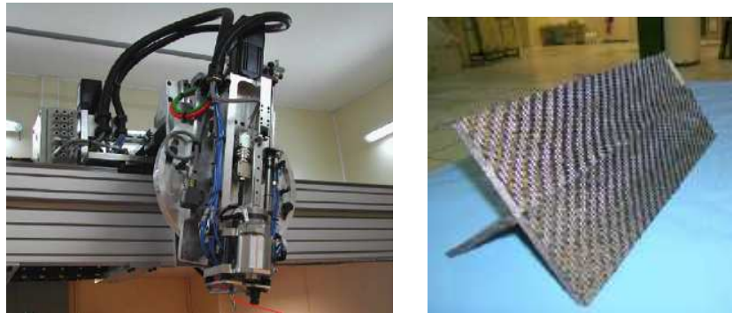
Figure IV-3 : Machine de cloutage (gauche) et barre de jonction en T clouté (droite) [LEFEBURE 2006]
