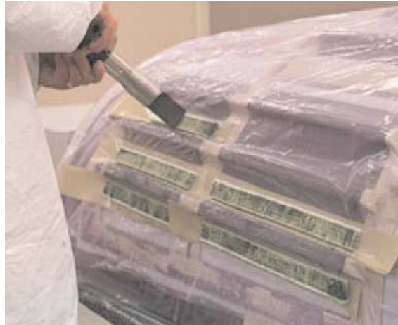
Figure I-3 : Insertion de clous lors de la fabrication des panneaux voilure du F/A-18E
