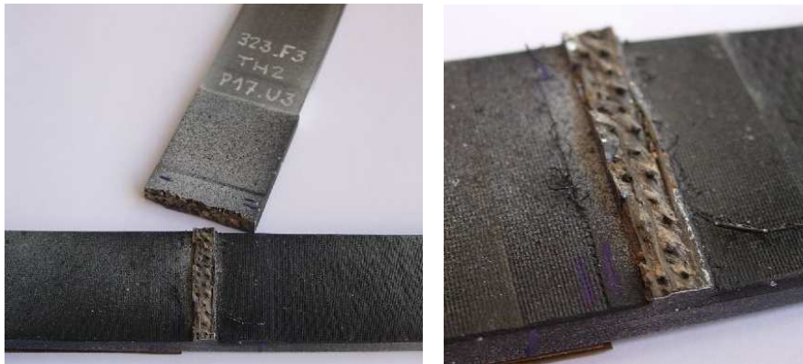
Figure IV-58 : Epreuve type f3-th2 après essai de cisaillement (gauche) et détail de l'interface (droite)
