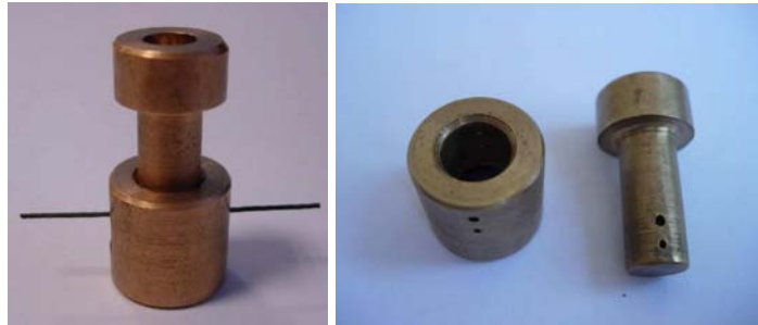
Figure III-11 : Pièces principales du montage de cisaillement du clou. On observe les deux orifices pour tester des clous de différents diamètres.
