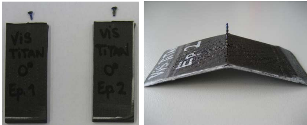
Figure III-90 : Epreuves après essais : rupture de la vis (gauche) et rupture de la peau en flexion (droite)
