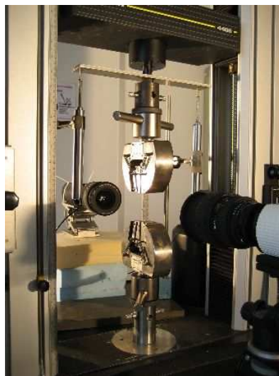
Figure III-60 : Positionnement des caméras lors d'un essai d'arrachement de clou
