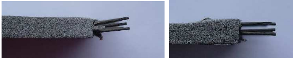
Figure IV-38 : Eprouvettes en T clous 40 mm (gauche) et clous 15 mm (droite) après essais d'arrachement
