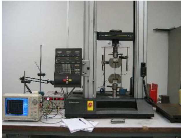
Figure III-59 : Montage d'essai d'arrachement de clou dans le stratifié
