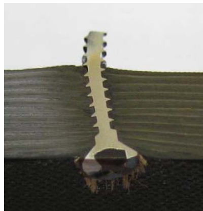
Figure III-91 : Découpe post-mortem d'une éprouvette type P5T. L'inclinaison de la vis dans le stratifié s'est produit pendant la fabrication de l'éprouvette
