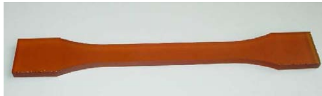
Figure III-19 : Eprouvette en forme « d'os de chien » pour caractérisation de la résine
