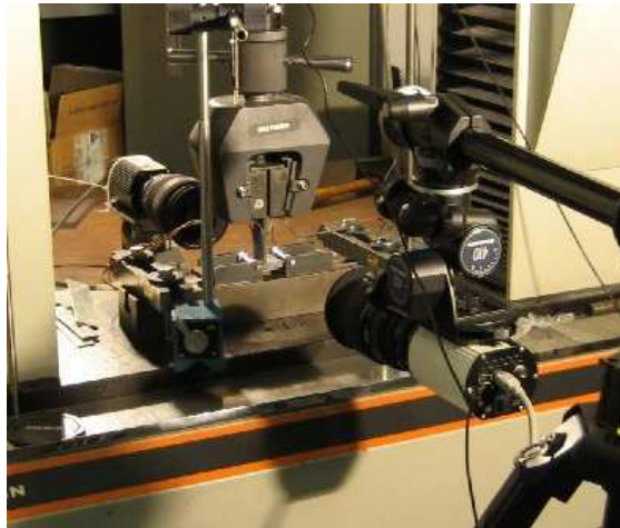
Figure IV-21 : Positionnement des caméras autour du montage en appuis simples
