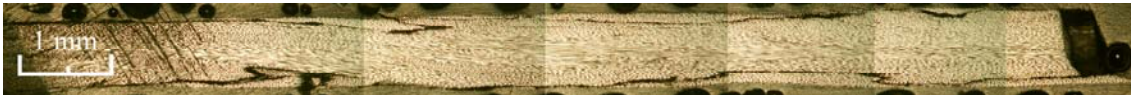
Figure III-79 : Micrographie d'un clou déchaussé. Essai sur éprouvette clous croisés arrêté avant la rupture des clous en cisaillement.
