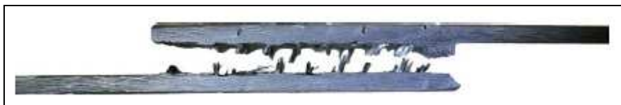
Figure II-65 : Vue de profil de la liaison avec clous 0,51 mm après rupture par déchaussement des clous [CHANG 2006 II]
