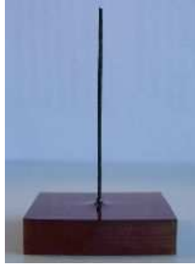
Figure III-28 : Epreuve d'arrachement de clou dans la résine
