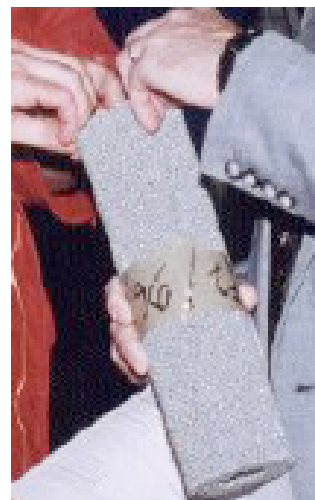
Figure 11 : Tube écrasable pour bielle extensible.
