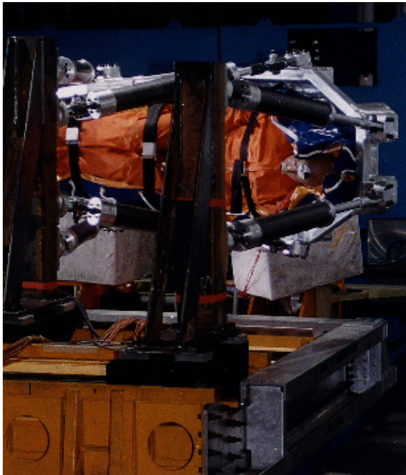
Figure 12 : Essai dynamique du siège.
