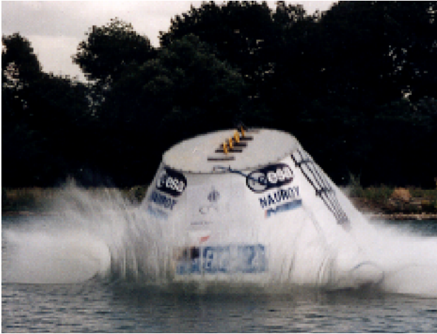
Figure 7 : Essai d'amerrissage vraie grandeur.
