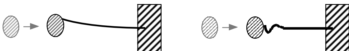
Choc avec Flambage Dynamique en déformée globale
