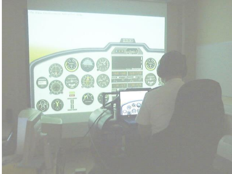
FIG. 7.9: Le pilote est assis dans la cabine de pilotage, et la visualisation est projetée par un vidéoprojecteur sur un écran.
