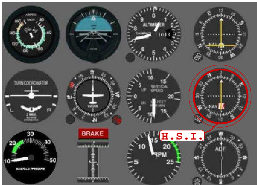
FIG. 7.4: Le H.S.I. (encadré de rouge) est un outil de radio navigation qui donne la route à suivre à l'aide d'un axe orienté.
