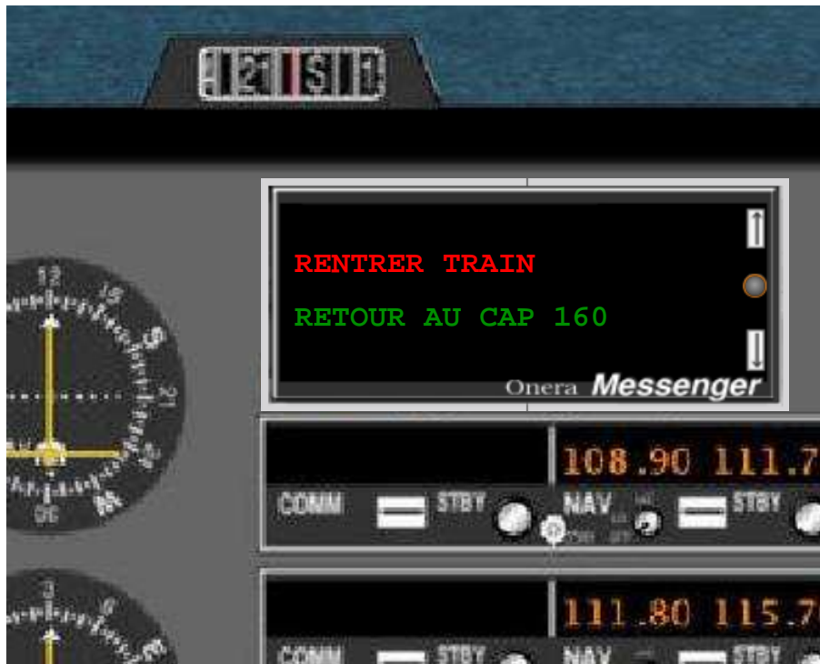
FIG. 6.3: Interface graphique Onera Messenger intégrée dans le cockpit pour les simulations. L'expérimentateur a la possibilité d'envoyer des messages de types alerte (en rouge) ou nominal (en vert), selon les besoins de l'expérimentation.
