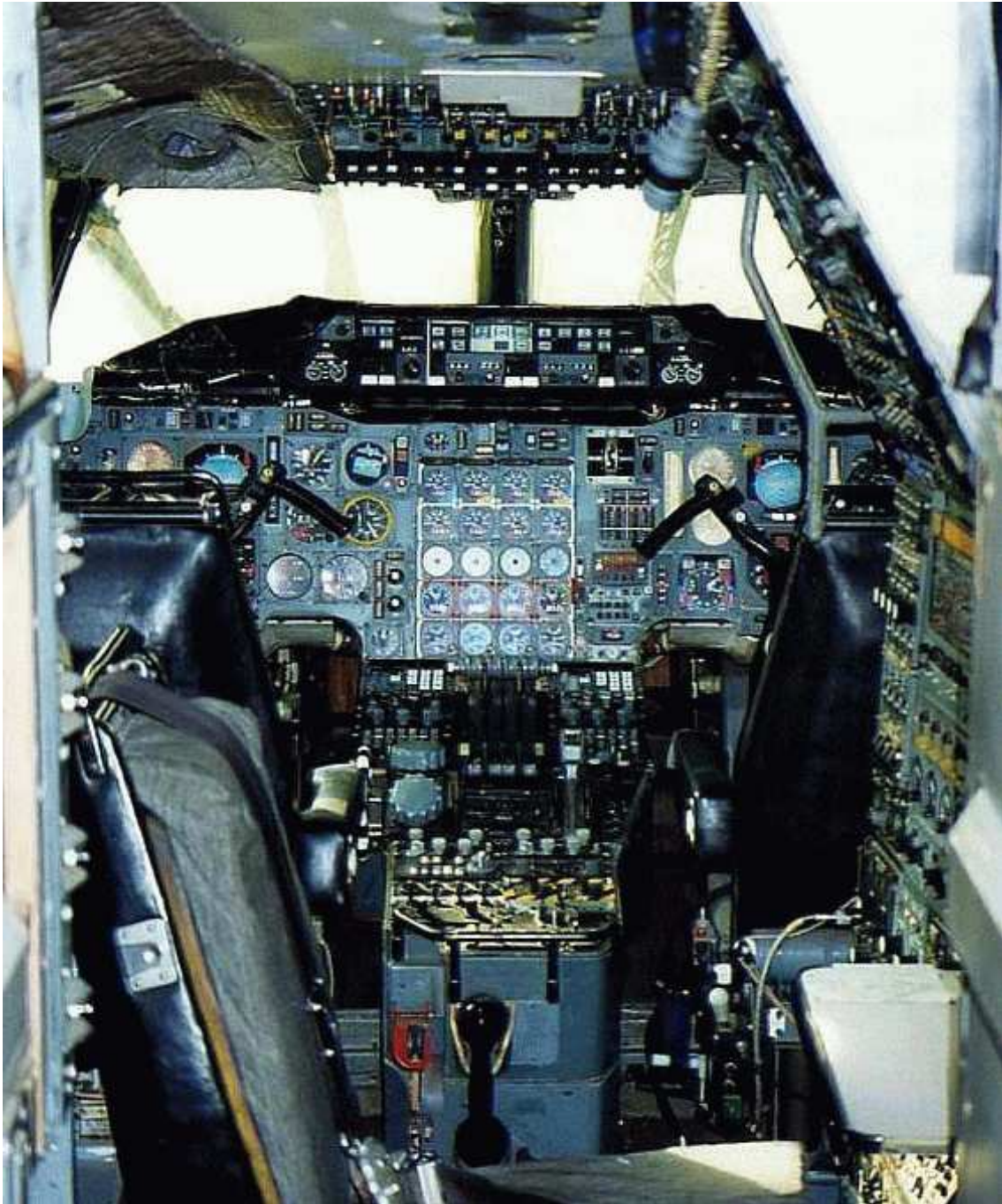
FIG. 1.1: Cockpit du Concorde : 3 hommes sont nécessaires pour faire voler cet appareil (pilote, copilote, mécanicien). L'interface pour contrôler le vol et les différents systèmes se fait par une multitude de cadrans analogiques.
