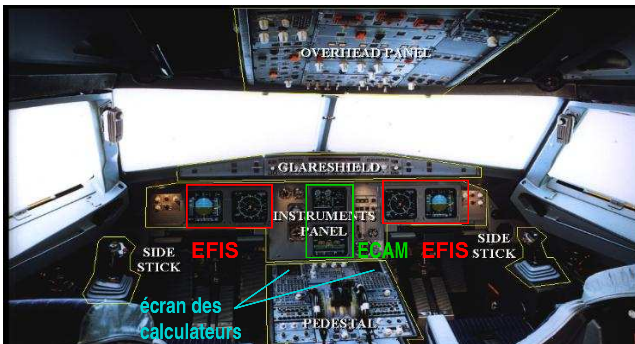
FIG. 7.12: Les EFIS, ECAM et les écrans du pedestal représentent les endroits possibles d'envoi de contre-mesures. En revanche, il est impossible de transmettre des contre-mesures sur le panneau supérieur ou "overhead panel".
