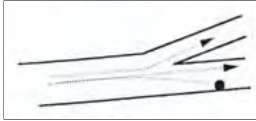
Figure 19 : Représentation schématique du phénomène de sédimentation gravitationnelle des particules.
