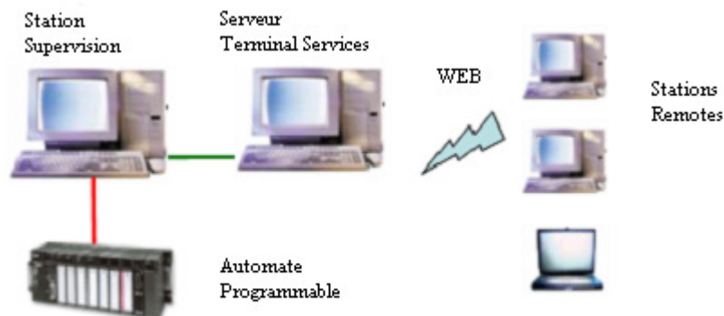
Figure 2 – Schéma de l'architecture de Commande
