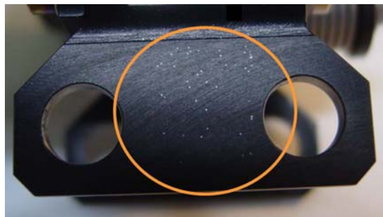
Figure 1 : Décohésion de particules sur une pièce anodisée.
