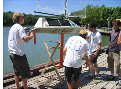
fig 1 : Vor 60 au 1/8 ème réalisé en 2004 en navigation (noter le gréement de type Balestron)
