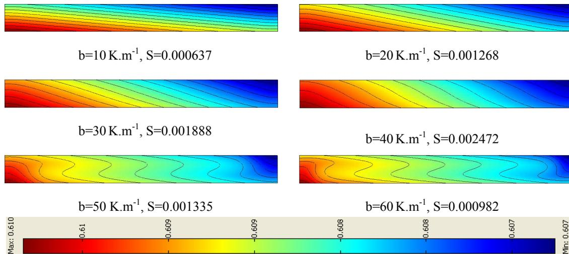
**Figure 3** Variation du champ de concentration en fonction du gradient horizontal de température  $b$ . ( $H=2\text{mm}$ ,  $L=20\text{mm}$ ,  $\Delta T=1\text{K}$ ). Les couleurs traduisent l'intensité de la fraction massique de l'eau.
