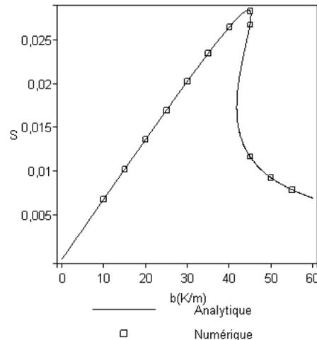
Figure 2 Résultats analytiques et numériques ( $H=2\text{mm}$ ,  $L=200\text{mm}$ ,  $\Delta T=1\text{K}$ ).
