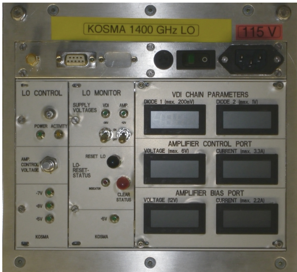
Abbildung 3.22.: Front des LOs mit Bedienelementen und Elektronikeinschüben.
