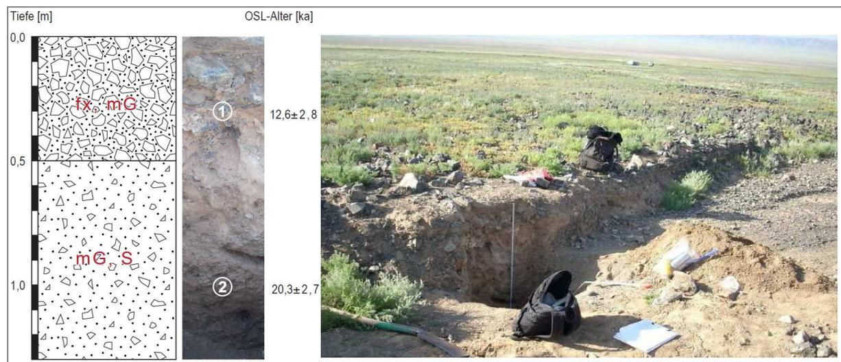
Abb. 7.2: Das Profil BT-F, die erzielten IRSL-Alter sowie die Umgebungssituation des Profils.
