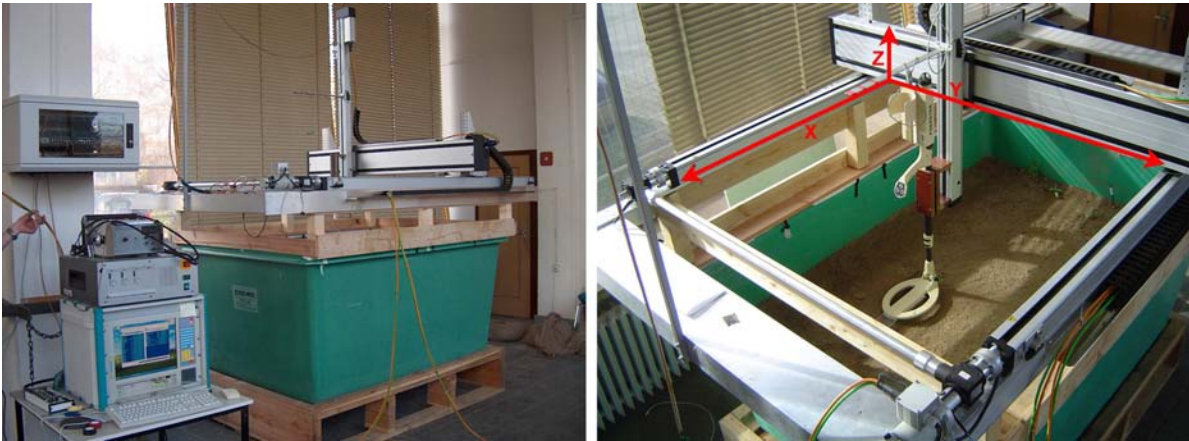
Abbildung 4.6: Laboraufbau in Rostock für die Messungen mit den Metalldetektoren. Der Aufbau besteht aus einer Wanne, einem Rahmen auf dem der 3-Achsen-Scanner aufliegt und einem MessPC (linkes Foto). Die roten Pfeile geben das in dieser Arbeit verwendete Koordinatensystem an.
