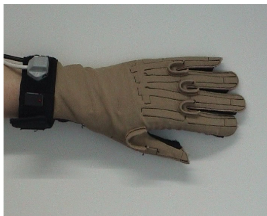
Abbildung 5.1: Datenhandschuh zur Erfassung der Handmotorik
