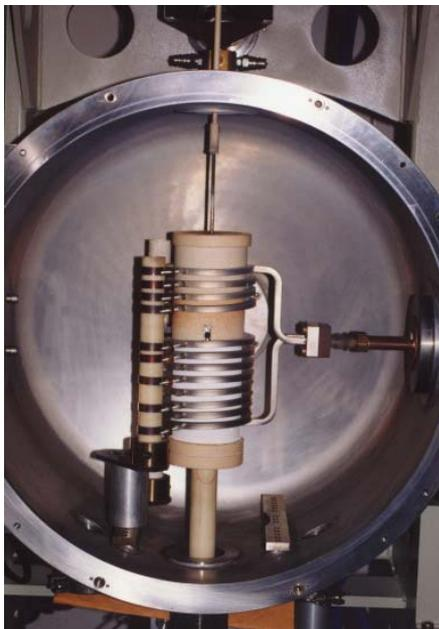
**Abb. 3.2** Rezipient der Czochralski-Anlage mit Induktionsspule (Tiegelbeheizung) und Nachheizerspule
