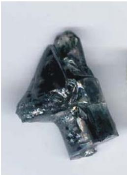
**Abb. 3.5** Durch hohe Abkühlrate undurchsichtig und dunkel gefärbter CBN-Kristall
