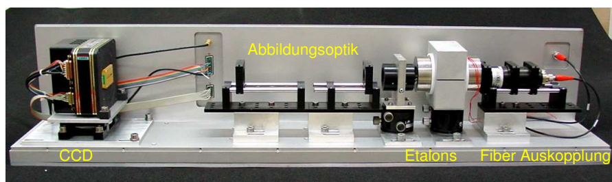
Abbildung 1.6.: Der Prototyp des Laser Seitenband Spektrometers. Entwickelt am I. Physikalischen Institut der Universität zu Köln [39].
