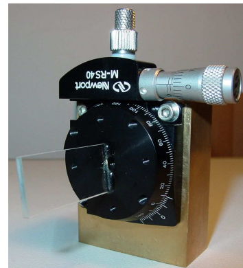
(b) Zur Messung verwendete Glasplatte auf dem Mikrometer-Rotationstisch.
