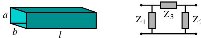
**Abbildung 3.1:** Gleichförmiges Hohlleitersegment der Länge  $l$  (links) und elektrisches  $\Pi$ -Ersatzschaltbild aus drei komplexen frequenzabhängigen Impedanzen (rechts).
