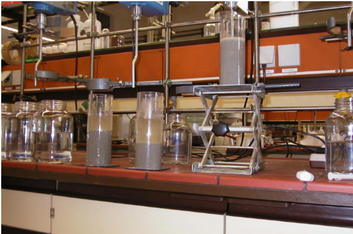
Abb.28 Versuch zum Sedimentationsverhalten von Carbonatschlamm aus Pf 6 mit Flockungshilfsmitteln, Labor der Stockhausen GmbH, Krefeld.
