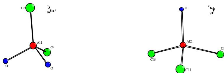
Abb. VI.4  $[Al(1)Cl_2O_2]$ - und  $[Al(2)Cl_3O]$ -Tetraeder in der Struktur von  $SnAl_2Cl_6O$
