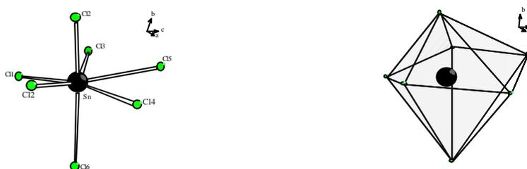
Abb. VI.6  $[SnCl_7]$ -Polyeder in der Struktur von  $SnAl_2Cl_6O$
