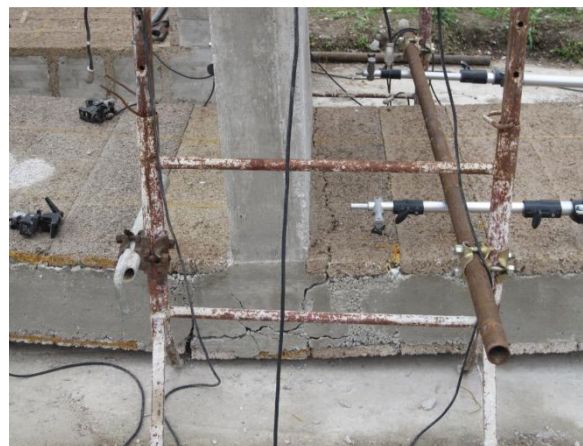
Figura 17 - Fessurazione delle sezioni più sollecitate
