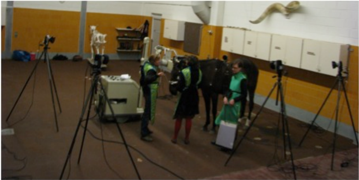
Figur 1. Placering av höghastighetskameror runt hästen vid röntgenundersökningen.
