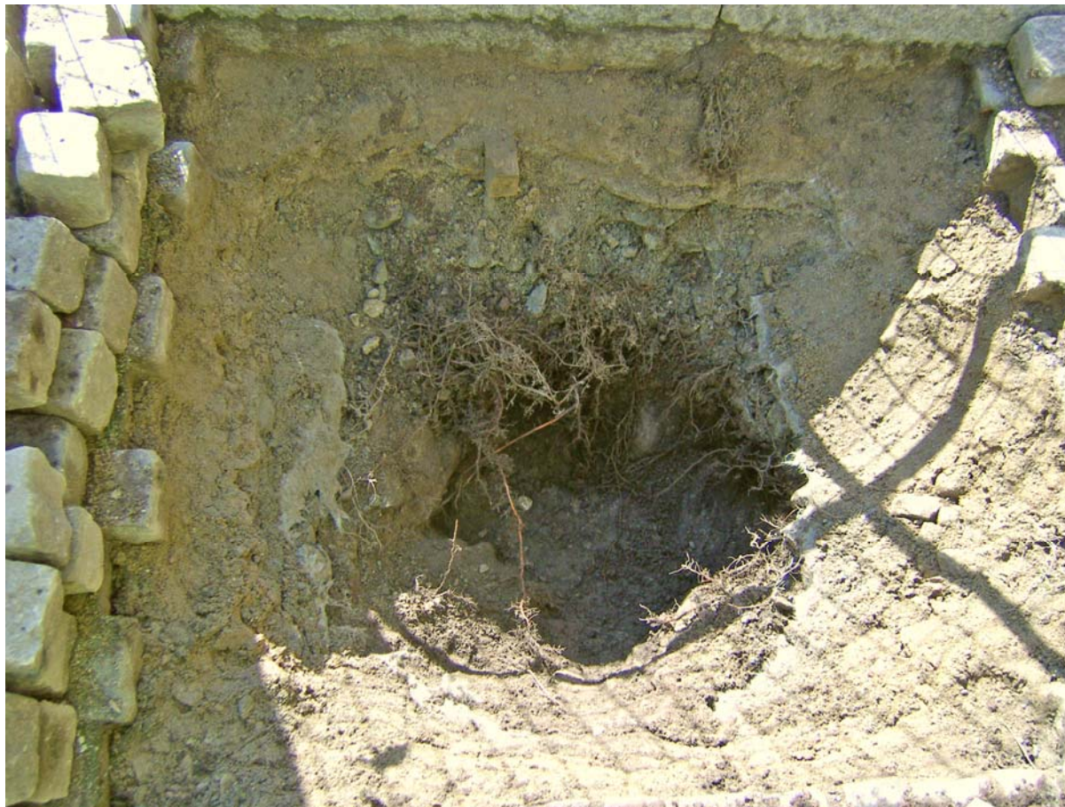
Erik Dahlbergs Allé, provgrop grävd 14/4 2008. De flesta rötter verkar på bilden finnas i övre delen av skelettjorden, precis i angränsning till det luftiga bärlagret. Foto: Björn Embrén
