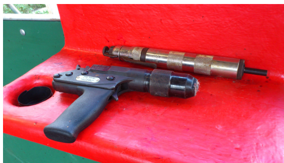
Figur 13. Två olika typer av bultpistoler, närmast en Cash special och längre in en Blitz-Kerner.
