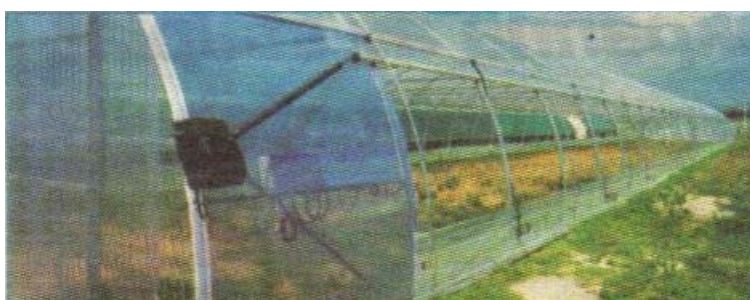
Figur 15. Till vänster på bilden ser man drivningen till nätupprullaren. Bilden är en annons från UBA – Uno Borgstrand AB, den är tagen ur ATL maj 2005.
