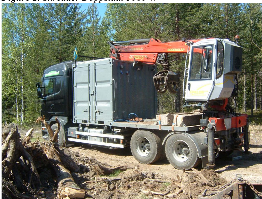
Figur 2. Kranlastbil Scania med timmerkran
