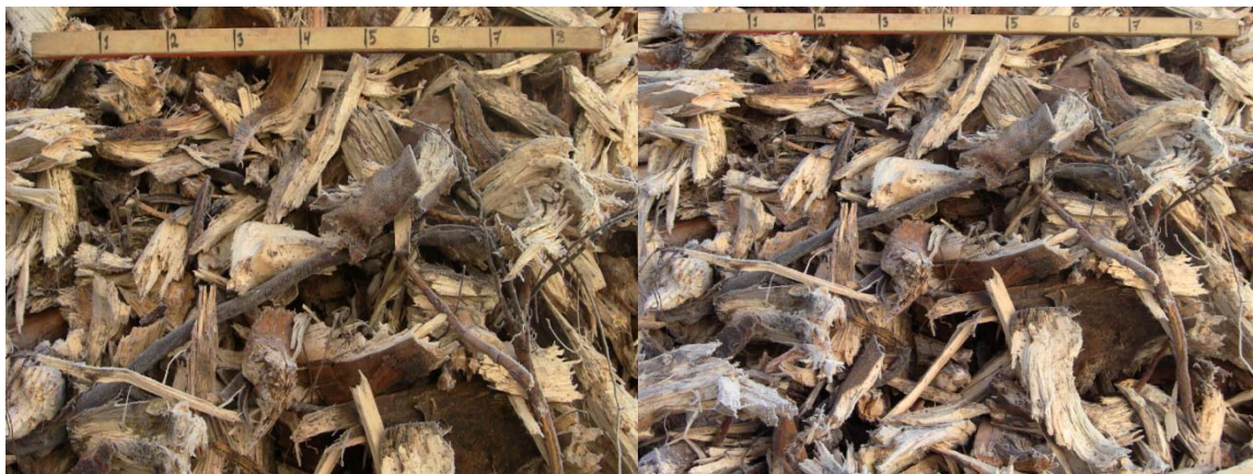
Figur 3. Det krossade materialets fraktionsstorlek vid fukthaltsprovtagning, måttstocken är en meter lång. Hög ett till vänster & hög två till höger.
