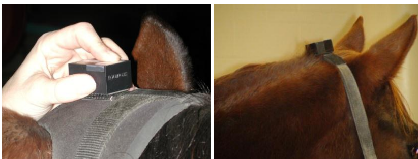
Bild 3 och 4. Placering av sensorn på huvudet, ur Lameness Locator™ training manual
