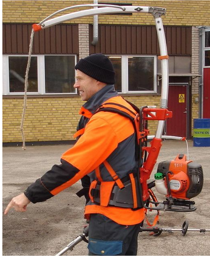
Figur 5.1. Kedjeröjsågens motorenhet upphängd som en ryggsäck. (foto, eget arkiv)
