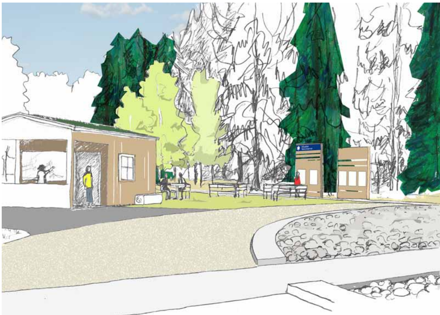
På bilden går det att se den upphöjda betongkanten mellan bilväg och entréområdets cirkel.
