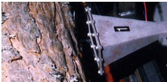
Figur 1. Testbild på en mikrovågssensor. (Eskelinen 2008, pers.med.)
