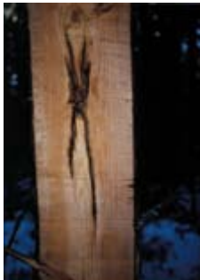
Figur 8. Här syns barkinvallning, missfärgning och fiberstörningar tydligt.
