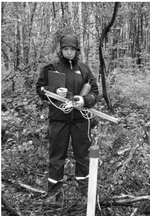
Figur 3. Grundvattenrör vid Skrotgården i Malmberget (objekt 15). På bilden syns även grundvattenprovtagare och en av de glasflaskorna som användes vid transport.
