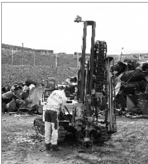
Figur 2. Borrbandvagnen GM75 som användes vid provtagning med skruvborr och moränborr samt vid förborring av hål för grundvattenrör
