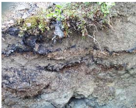
Figur 36. Jordprofil från provgrop 1 på Oljegropar på jordtippen (objekt 7). De två oljelagren syns tydligt och under respektive oljelager kan man urskilja ett lager med sågspån. På plats kunde man även se tydligt se rötslam och sandlagret.
