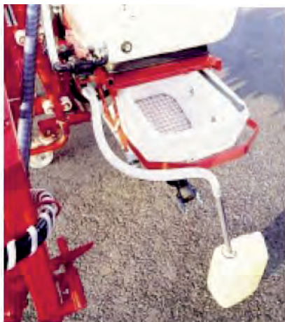
Figur 3. Sugspjut för säker påfyllning av sprutvätska. ( Nilsson m. fl., 2000 )
