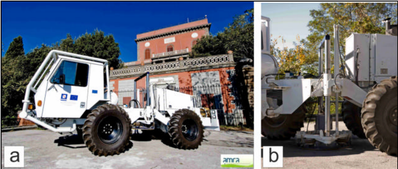
Fig. 5. a) veicolo Ivi-MiniVib®; b) particolare del sistema vibrante. Le frequenze di oscillazione in esercizio del MINIVIB vanno da 5 Hz a 550 Hz.
