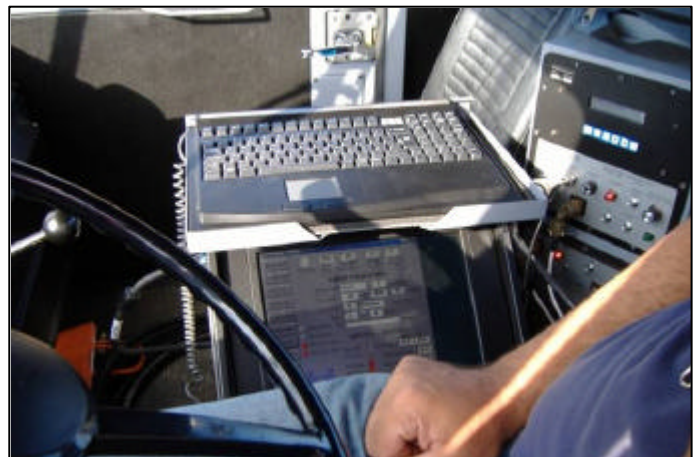
Fig. 6. PC di controllo installato all'interno del Minivib
