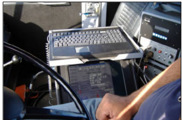
Fig. 8. PC di controllo installato all'interno del Minivib
