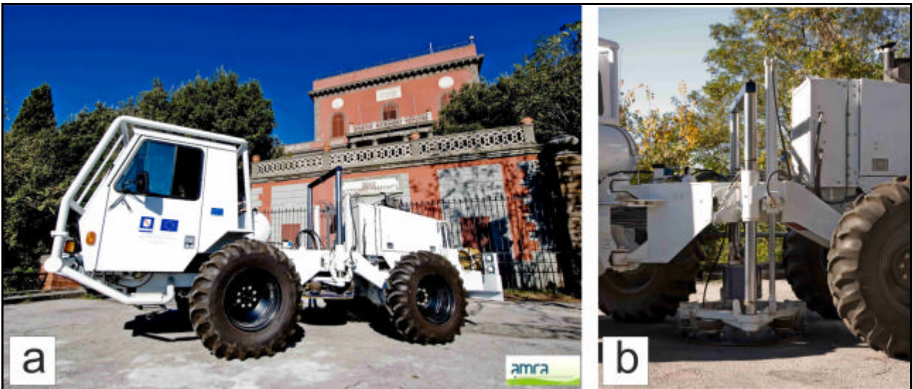
Fig. 7. a) veicolo Ivi-MiniVib®; b) particolare del sistema vibrante. Le frequenze di oscillazione in esercizio del MINIVIB vanno da 5 Hz a 550 Hz.
