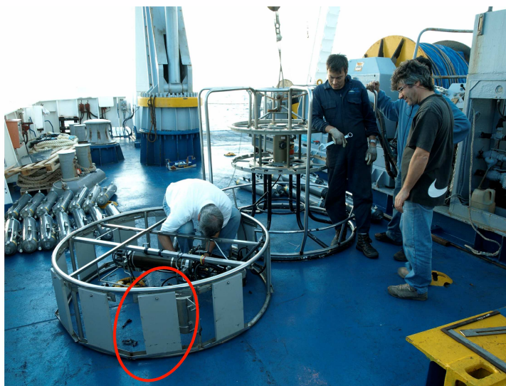
Figura 2 - A: Modifiche apportate al sistema CTD - il cerchio rosso indica i nuovi pesi applicati;
