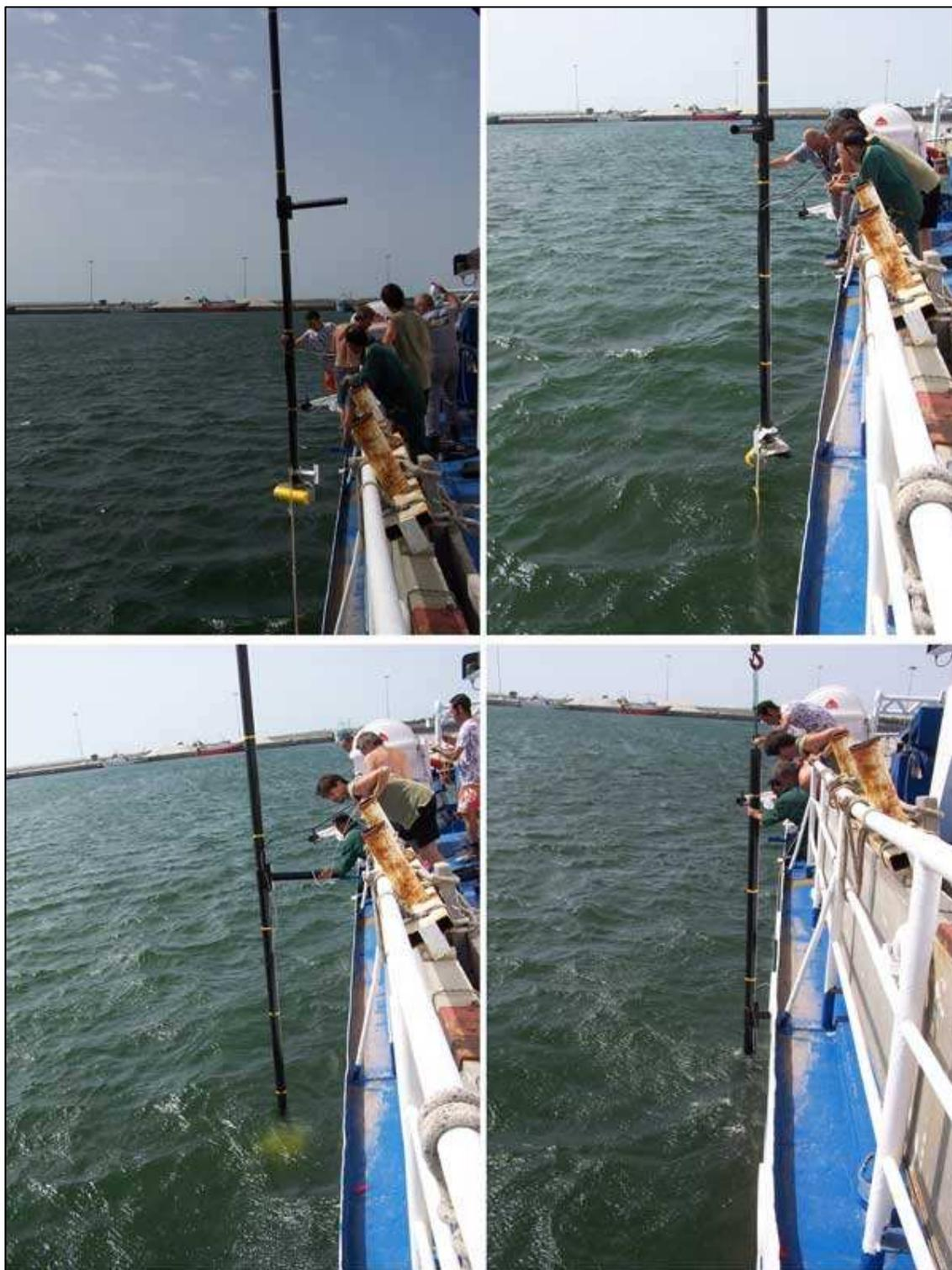
*Fig. 19 – Messa in acqua del SeaBat 8125 montato a palo*
