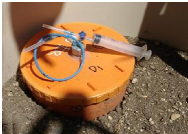
Figura 10. Camere manuali statiche in PVC e il metodo di campionamento dell'area
