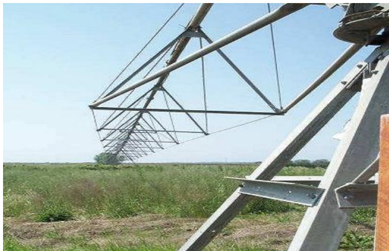
Figura 7. Sistema di Irrigazione Pivot-Centrale
