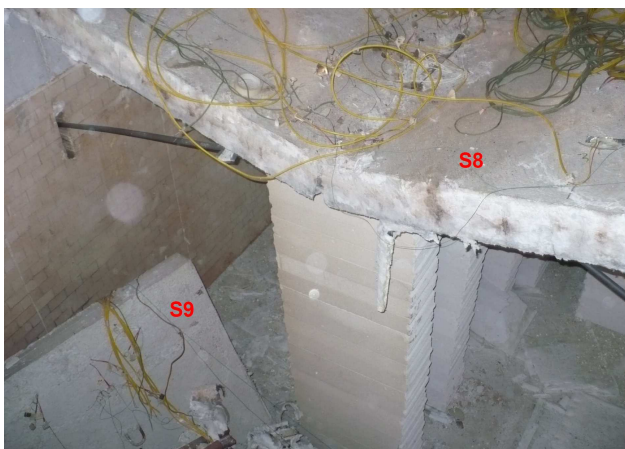
Figura 5.47 Solette S8 ed S9 della Prova del Set III in condizioni di rottura
