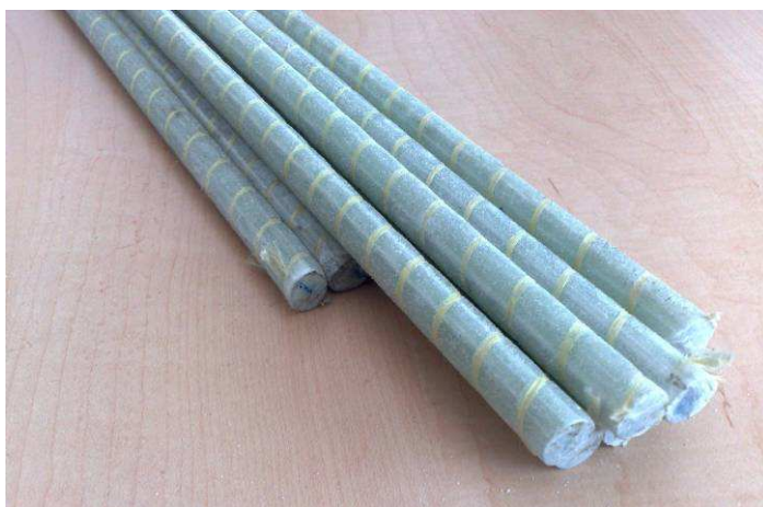
Figura 5.7 Barre di GFRP adottate all'interno delle solette oggetto di studio
