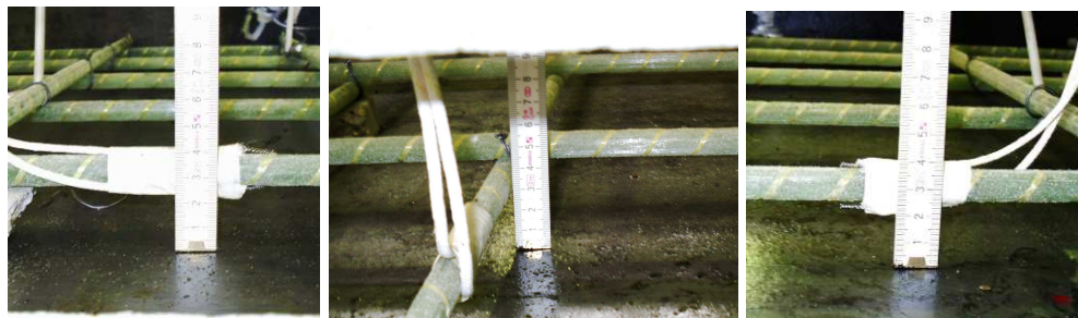
Figura 5.28 Particolare di disposizione delle termocoppie e verifica del copriferro di 51mm, valutato rispetto all'asse della barra, rispettivamente sulle solette S7, S8 e S9
