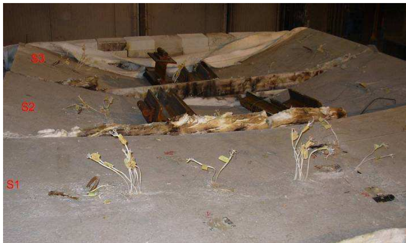
Figura 5.43 Solette S2 ed S3 della Prova del Set I in condizioni di rottura
