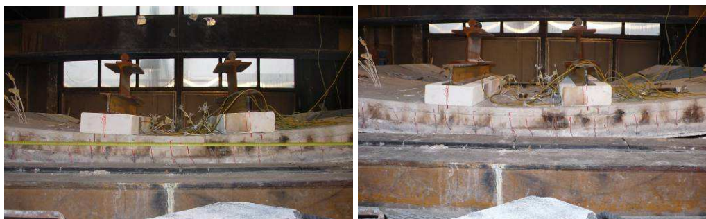
Figura 5.44 Sequenza della prova di carico residuo sulla soletta S1
