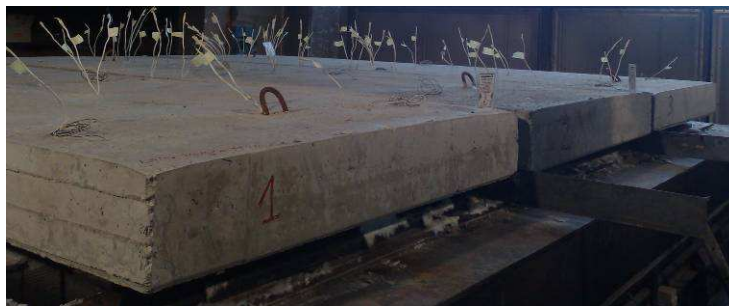
Figura 5.33 Solette S1, S2 ed S3 poste a chiusura delle bocche del forno
