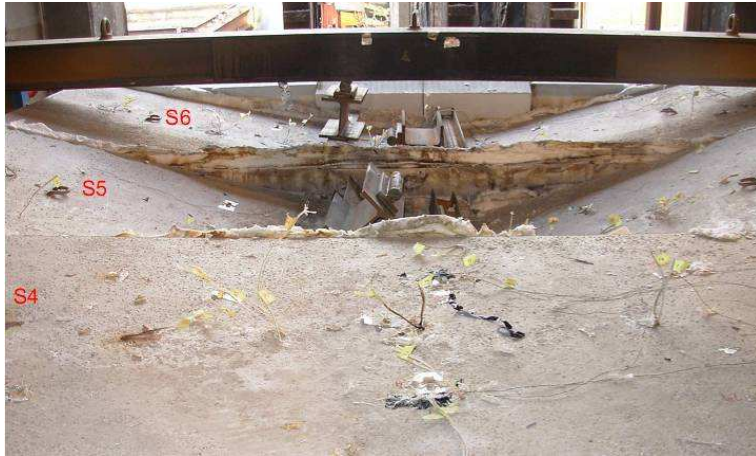
Figura 5.45 Solette S5 ed S6 della Prova del Set II in condizioni di rottura
