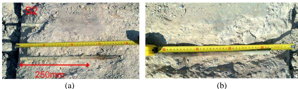
Figura 5.60 Particolari delle barre del Set I: (a) assenza di sfilamento; (b) presenza di sfilamento
