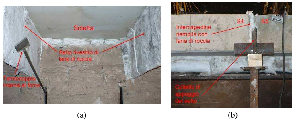
Figura 5.34 Particolare dell'isolamento: (a) interno del forno relativo al setto; (b) intercapedine tra due solette consecutive riempito con lana di roccia
