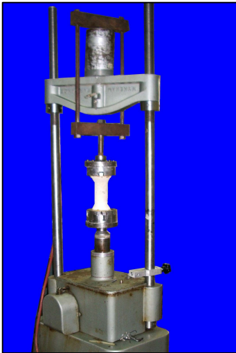
Fig. 3.25 Pressa utilizzata per le prove di trazione. Anellini contenimento e basi
