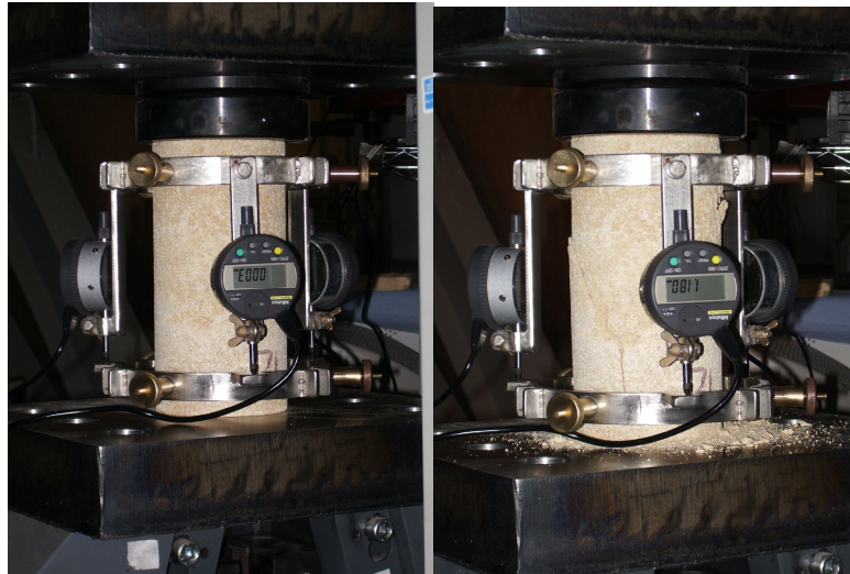
Fig. 4.24 - Provino CL1 prima (a) e dopo (b) la rottura.
