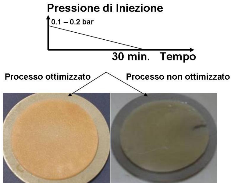
Figura 5. Esempio di bioibridi ottenuti da camere riempite con flussi ottimizzati (sinistra) e con alte pressioni (destra)
