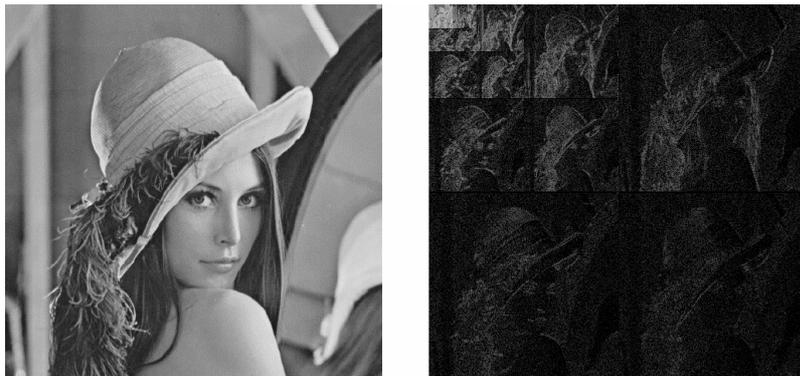
**Figura 3.15:** Analisi wavelet diadica di un'immagine ( 2 livelli di decomposizione).
