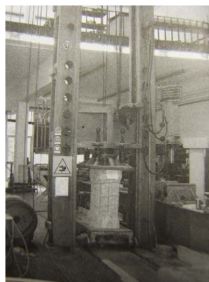
Figura I.2.4: Prove di compressione su campioni di pilastro dell’edificio crollato nel 2001
