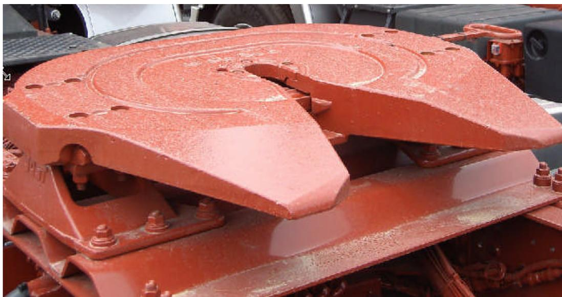
**Figura 11-11: ralla montata su motrice IVECO**
