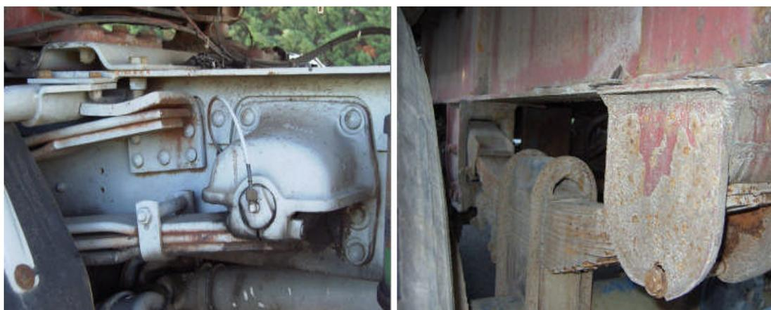
Figura 11-22: attacchi delle balestre del trattore e del rimorchio
