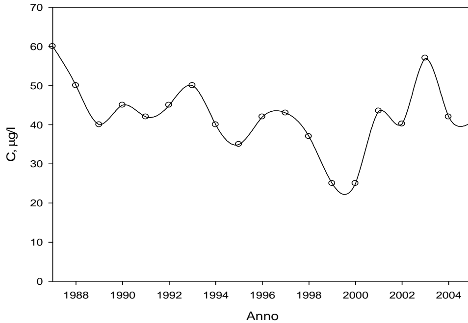
Figura II.10 – Andamento delle concentrazioni di tricloroetilene negli anni 1987-2005 all'interno di un pozzo spia posto nel territorio del Comune di Aviano
