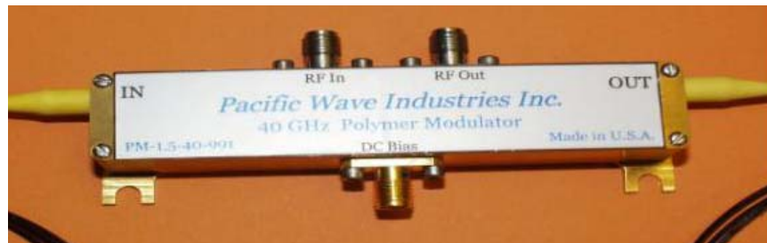
Figura 4.12 – Esempio di modulatore elettro-ottico a base polimerica
