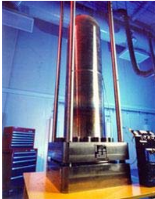
Figura 1.9: Foto di una fornace dove il CdTe è fuso durante il processo ad alta temperatura.
