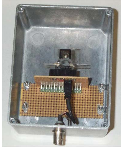
Figura 4.2: Fotografia del rivelatore ed dell'elettronica di front end per la spettroscopia alfa.
