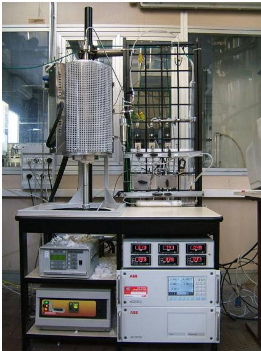
**Figura II.1.2. Fotografia dell'impianto a letto fluido in scala da laboratorio.**
