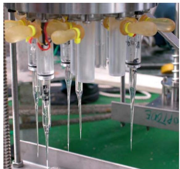
Neben den fest am ROV montierten Sensoren sollen noch weitere Sensoren (s. Abb. mit einem sogenannten Profiler-Modul) innerhalb des Logatchev Hydrothermalgebietes für mehrere Stunden bzw. Tage abgesetzt werden, um Parameter wie O<sub>2</sub>, H<sub>2</sub>, H<sub>2</sub>S, pH und Temperatur an den diffus austretenden Lösungen in definierten Zeitintervallen zu messen.
