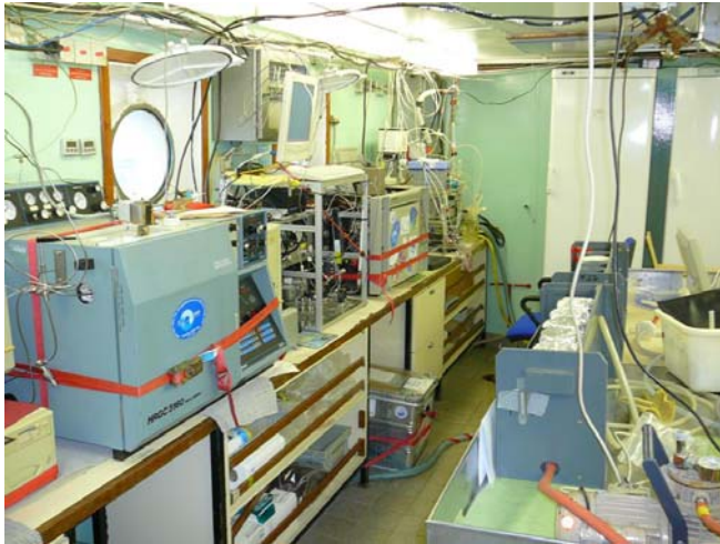
Blick in das Nasslabor von Poseidon mit Messsystemen zur Analyse von \text{N}_2\text{O} , \text{CH}_4 und \text{CO}_2 (links) und Filtrationsanlage zur Filtration von Chlorophyllproben (rechts).
