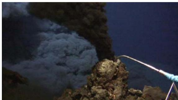
eines Anstiegs der hydrothermalen Aktivität zumindest an einigen Austrittsstellen. Um den weiteren Temperaturverlauf dokumentieren zu können, wurde ein Temperaturfühler ausgesetzt, der die Austrittstemperatur für die nächsten 13 Monate aufzeichnet. Dieser soll, wie auch die
